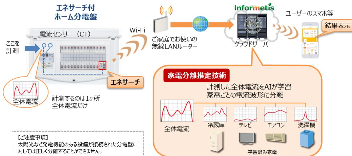
エネサーチ付ホーム分電盤は、インフォメティスが開発した家電分離推定 AI に対応した電力計測装置が組み込まれた一般家庭用分電盤です。エネサーチは主幹ブレーカ部に電流センサー1組だけを取り付けて家全体の電流だけを計測し、そのデータをクラウドサーバーの AI で分離・分析することにより、家電毎の電力使用情報を把握できます。これにより、今お使いの家電や電気配線はそのまま、手軽にホーム IoT の構築を実現しています。なお、家電の買い替えがあっても AI が自動で学習していきます。従来一般の HEMS ホーム分電盤では分岐ブレーカ毎に測定するため、回路毎の消費電力はわかりますが、単独回路が割り当てられるエアコンなどを除いて家電毎の把握はできないのが一般的です。また、家電毎の使用情報を把握するには、インターネット接続機能を備えた家電に買い替えたり、消費電力を計測するスマートタップを家電毎に設置したりする必要がありました。エネサーチ付ホーム分電盤は、これらの問題を解決いたします。
